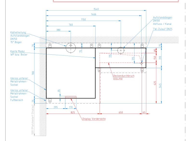
Leerrohre schmutzwasserdicht verschließen! Fundamentplan SA-Etech Wärmepumpe + Hydrotower - Basis 9 / 12 / 16kW 350 Liter
