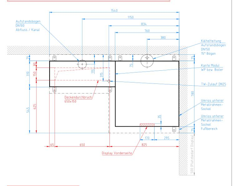
Leerrohre schmutzwasserdicht verschließen!
